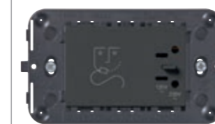
09290.CM 230 V~ 50/60 Hz, cu transf de izolare 20 VA, ieșire 230 V~ și 120 V~ - 3 module. Adâncime: 42 mm
