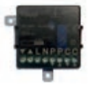
03996 Modul releu centralizabil, cu orientarea lamelilor, cu ieșiri pe releu pentru motor cosφ 0,6 2 A 220-240 V~ 50/60 Hz, memorarea poziției, instalare în cutii de derivație sau în cutii electrice
