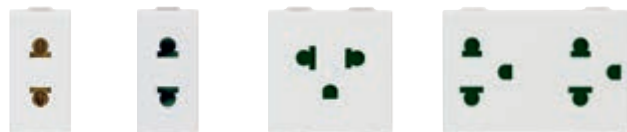
09233 2P 16 A, Euro-americană (ø 4,8 mm). Adâncime: 30 mm 09234 SICURY 2P 16 A, Euro-americană. Adâncime: 30 mm 09248 SICURY 2P+T 16 A, Euro-americană - 2 module. Adâncime: 26,5 mm 09249 2 SICURY 2P+T 16 A, Euro-americană - 3 module. Adâncime: 24,5 mm
