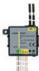
01477 Modul cu 2 intrări digitale programabile pentru contacte fără potențial, 1 ieșire cu releu cu comanda luminilor NO 10 A 120-230 V~ 50/60 Hz, 2 ieșiri pentru pilotare LED, domotică By-me, instalare prin încastrare (modul posterior)
