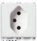
14226 2P+T 10 A, Elvețian, tip 13 - 2 module. Adâncime: 41 mm
