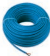
01840.E.B Cablul pentru difuziune sonoră, 2x0,50 mm 2 , înveliș din LSZH, clasă CPR Eca, adecvată pentru instalarea cu cabluri de Categoria I (U 0 = 400 V), albastru - 100 m
