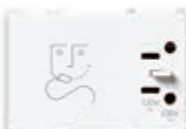
14290.AB Priză pentru aparate de ras cu transformator de izolare 20 VA, ieșire 230 V~ și 120 V~ - 3 module. Adâncime: 41 mm
