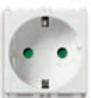
14208.FX SICURY 2P+T 16 A, Germană - 2 module. Adâncime: 32,5 mm
