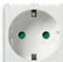
14208.AB Priză SICURY 2P+T 16 A 250 V~, standard german - 2 module. Adâncime: 28,4 mm
