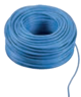
732H.E.100 Cablu Due Fili Plus pentru montare la interior, conductoare torsadate 2x1 mm 2 , înveliș din PVC, clasă CPR Eca, temperatură de funcționare -25/+70 °C, nu este adecvat pentru trecerea prin canale îngropate, adecvată pentru instalarea cu cabluri de Categoria I (U0 = 400 V) albastru - rolă de 100 m
