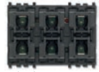
▲01487 6 butoane + actuator 1 jaluzea cu orientarea lamelilor, ieșire cu releu pentru motor cosφ 0,6 2 A 120-240 V~ 50/60 Hz - 3 module Adâncime: 37 mm
