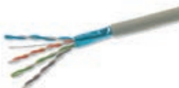
03061.E Cablu Cat. 5e F/UTP, ecranat, 4 perechi, 24 AWG, cu teacă LSZH, clasă CPR Eca, adekvată pentru instalarea cu cabluri de Categorია I (U0 = 400 V), gri - 305 m
